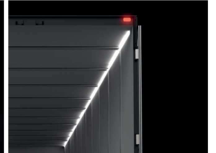
Innenbeleuchtung LKW-Trailer / Befestigung mittels Eckprofil
